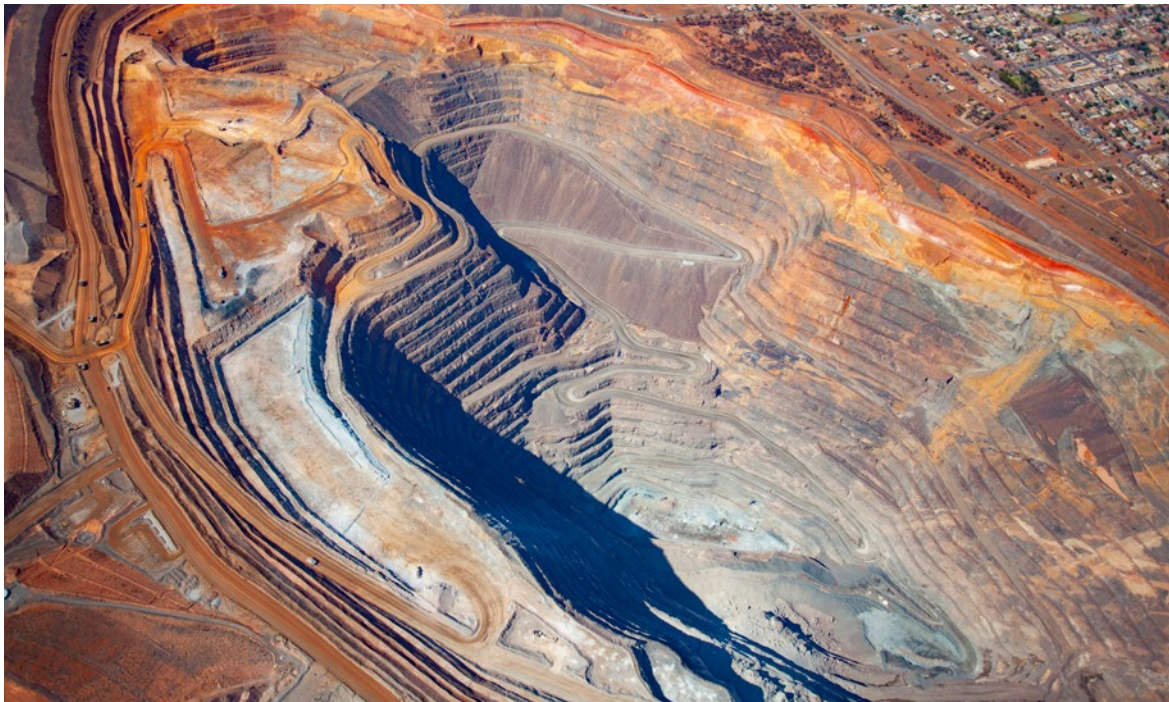
Gold: Die sogenannte Super Pit im australischen Kalgoorlie ist ein im Tagebau betriebenes Goldbergwerk. Die offene Mine (Länge: 3.5 Kilometer; Breite: 1.5 Kilometer; Tiefe: über 600 Meter) ist die flächenmässig grösste Goldmine Australiens.
